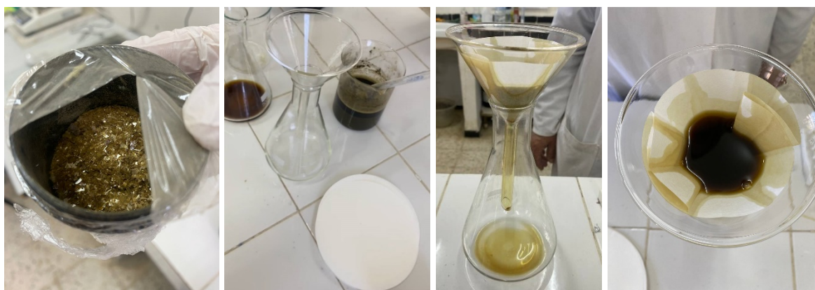
Figure12. Étapes de macération et de filtration pour la préparation de l'extrait méthanolique des feuilles de Camellia sinensis (thé vert)
